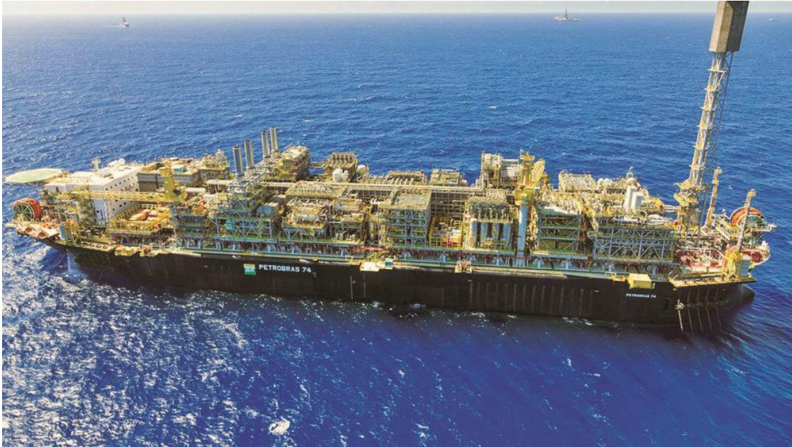
Unidade Flutuante de Produção, Armazenamento e Descarregamento usado pela Petrobras em atividade petrolífera - Foto: Reprodução Petrobras
